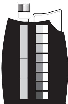
El Visor Octa-Slide 2 debe sostenerse de manera que entre la luz indirecta por la parte posterior del visor. Introduzca la barra Octa-Slide 2 en el visor. Inserte la muestra de reactivos en la parte superior del visor. Compare el color de la reacción con los estándares de color.
